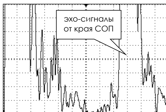
Вид экрана дефектоскопа на поисковой чувствительности (+12 дБ)
