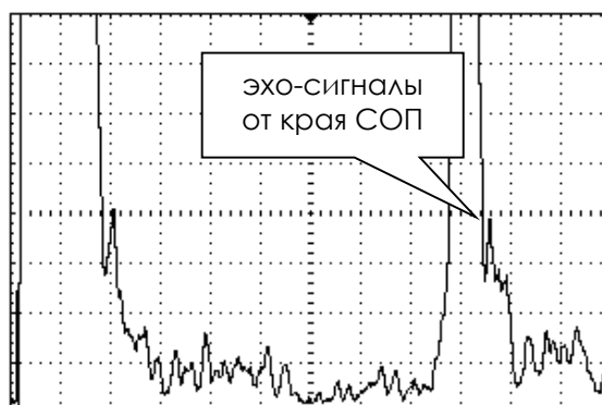
Вид экрана дефектоскопа на поисковой чувствительности (+12 дБ)
