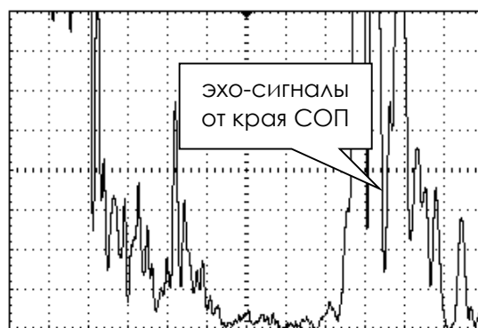
Вид экрана дефектоскопа на поисковой чувствительности (+12 дБ)
