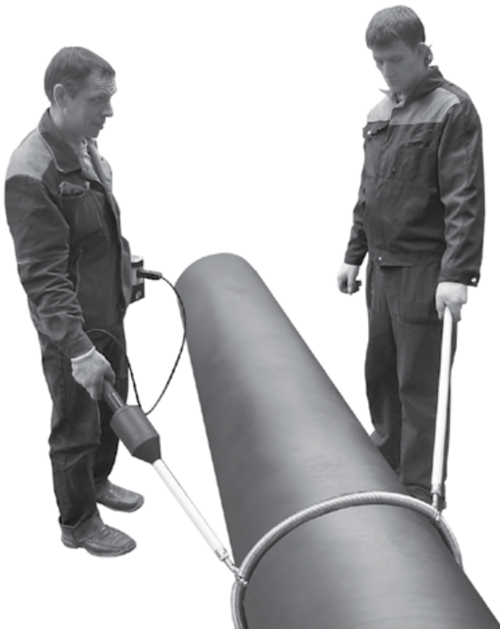
Рис. 9. Электрод пружинный (кольцевой) для контроля внешних покрытий труб.
