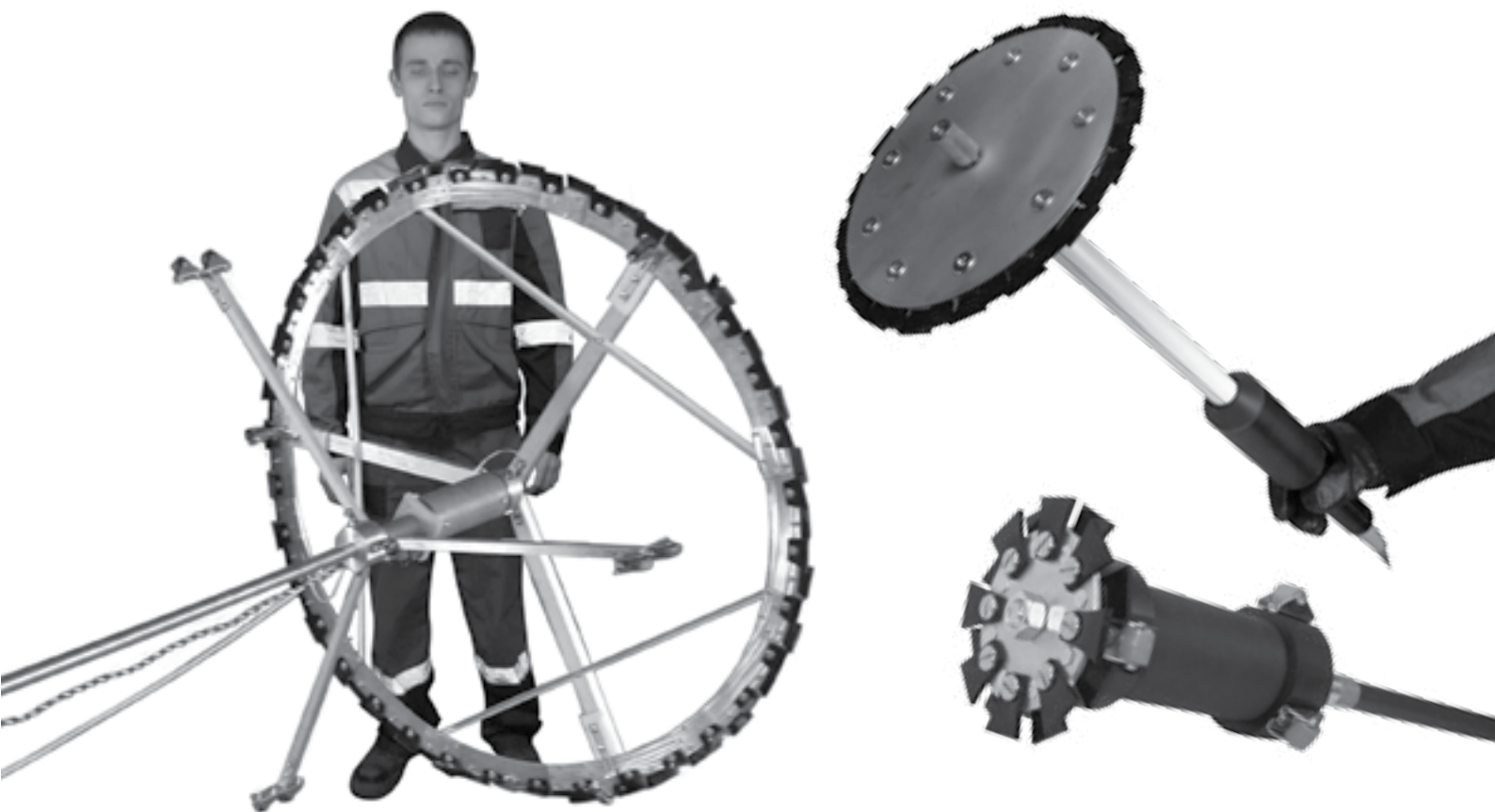
Рис. 10. Стандартные и специализированные электроды для контроля внутренних покрытий труб.
