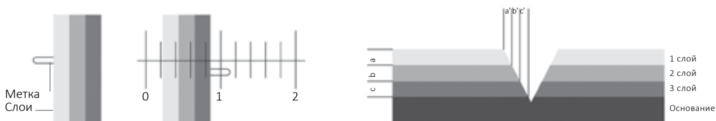
Рис. 14. Схематическое пояснение к методу измерения толщины покрытия.
