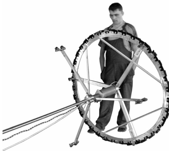
Внутритрубный электрод на диаметр трубы  $\varnothing 1420$  мм
