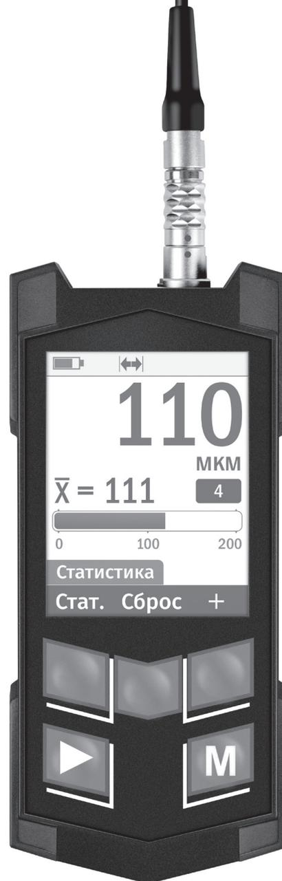
Режим работы с автоматическим усреднением и допусковым контролем
