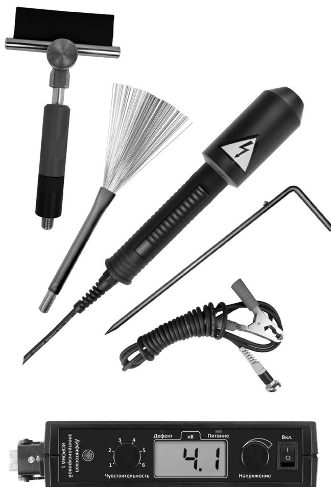
Прибор может комплектоваться дополнительными сменными резиновыми или волосяными электродами с зоной контроля от 50 до 400 мм, а также специализированными электродами для контроля внешних и внутренних покрытий труб диаметром от 50 до 820 мм.
