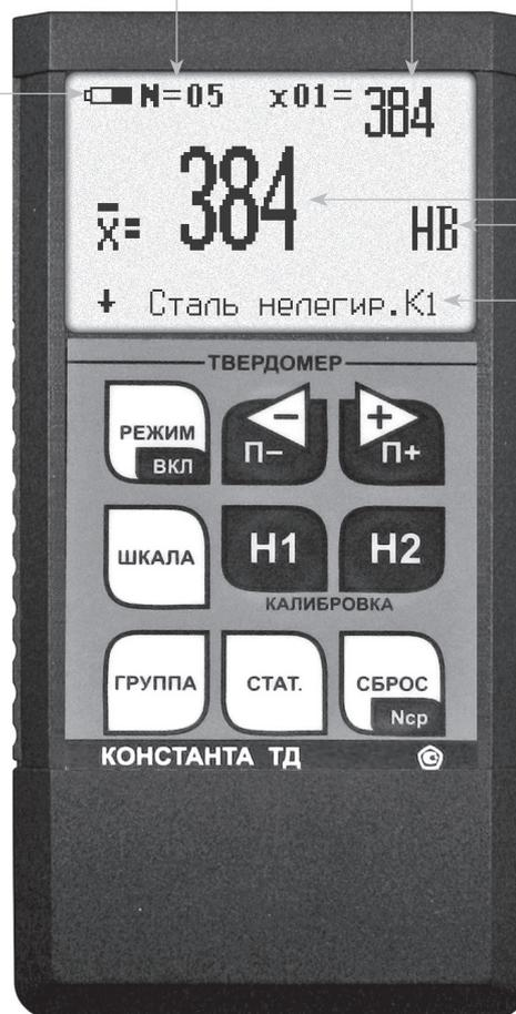
Работает со сменными преобразователями: D, DC, DL, D + 15, G, C.
