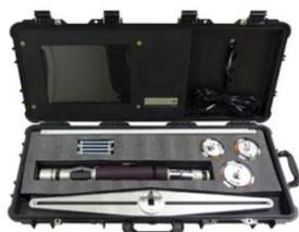
Система контроля паровых турбин, эксплуатирующийся при температуре пара 450 °С и выше, предназначена для проведения работ при продлении срока их эксплуатации сверх паркового ресурса. Система отвечает требованиям инструкции СО 153-34.17.440-2003 и позволяет проводить визуальный, ультразвуковой и вихретоковый контроль стенок осевого канала роторов паровых турбин.
