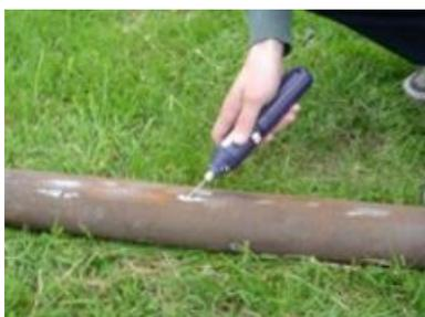
Малая зачистная машинка. Предназначена для подготовки поверхности (зачистки контактных пятен на корродированных и покрытых слоем краски поверхностях толщиной до 200 мкм) при измерении твердости металлов, проведении работ по ультразвуковой дефектоскопии и толщино-метрии. Благодаря малым габаритам («карманное» исполнение) обладает наибольшей мобильностью.
