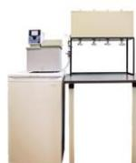
Комплекс используется в лабораторных условиях при испытаниях по определению реологических свойств жидкостей (вязкости, плотности и др.) и предназначен для автоматического поддержания заданной температуры стандартных образцов вязкости и других контрольных жидкостей.
