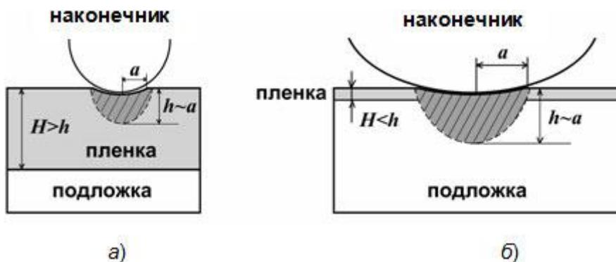
Рис. 2. Иллюстрация влияния подложки на измерение твердости пленок и покрытий.
