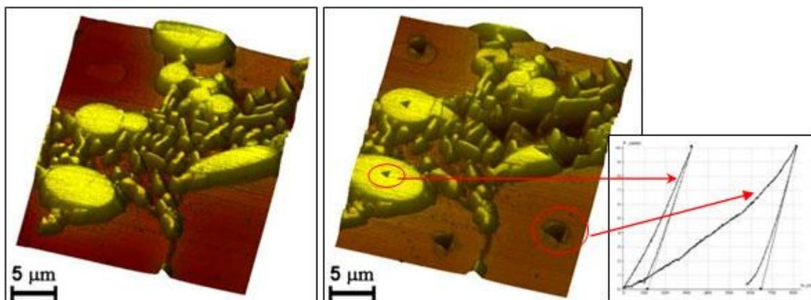
Рис. 3. Измерение свойств отдельных фаз микроструктурированного материала (алюминиевый сплав Д16).
