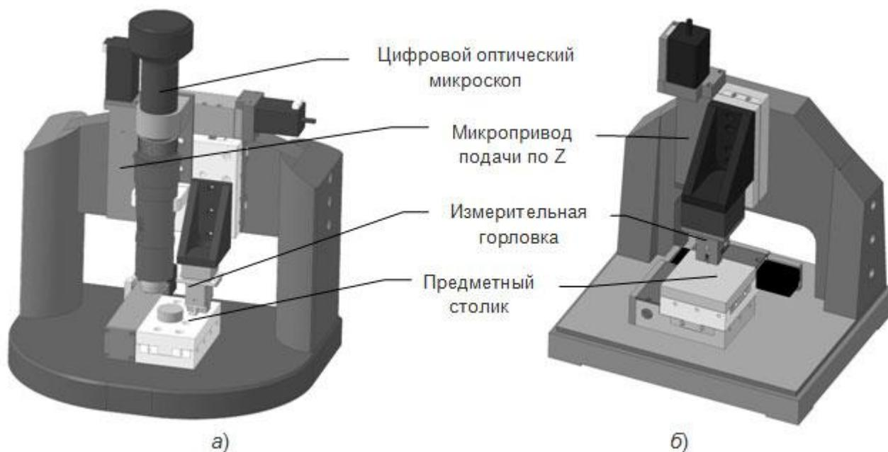
Рис. 6. Варианты исполнения микро/нано твердомеров (в том числе с функцией скратч-тестера – а)
