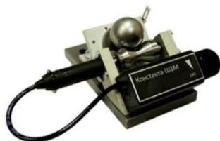
Измерительная лаборатория представляет собой комплекс, состоящий из толщиномера шарового истирания Константа-Ш1 и многофункционального электромагнитного толщиномера Константа-К6 Гальванический.
