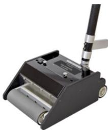
Предназначен для обнаружения коррозионных повреждений, расположенных на наружной и внутренней поверхностях днищ цилиндрических резервуаров, без удаления защитного покрытия, с использованием метода эффекта Холла для анализа магнитного поля рассеяния дефекта в соответствии с ГОСТ 24450.
