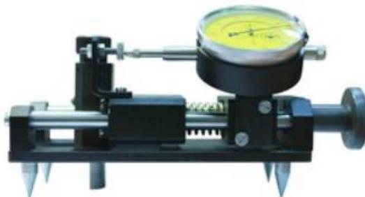
Прибор предназначен для определения адгезии (усилия прилипания) битумного или полимерного изоляционного покрытия к поверхности трубопровода при контроле качества изоляционных работ в полевых и заводских условиях в соответствии с ГОСТ Р 51164:
